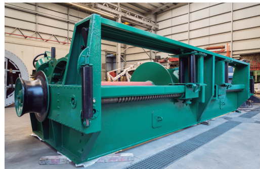
Maquinilla de Pesca CARRAL tipo C/II reconstruida en nuestros talleres
